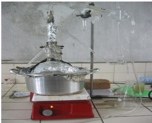
Gambar 3. Alat Destilasi Stahl
